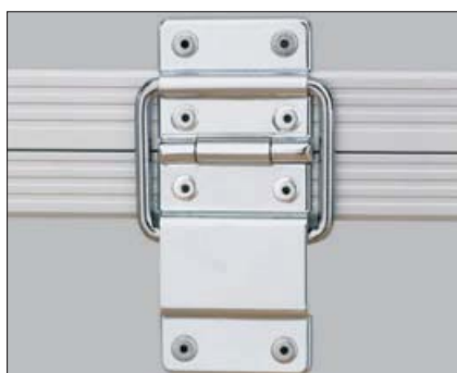
Art. nr. 620247: Stopscharnier, verchromd, 8-gaats, opening 93°
